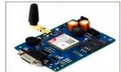
Fig. 9. GSM Module
