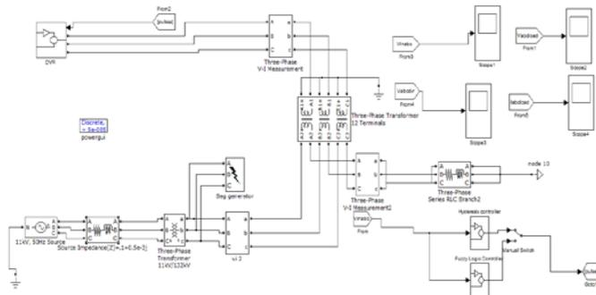
Fig. 9 Matlab/Simulink Model
